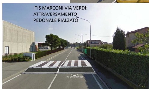
FIGURA 6.3.8 - UN INTERVENTO DI MODERAZIONE DEL TRAFFICO PER VIA VERDI (INCROCIO BUTTARO)
